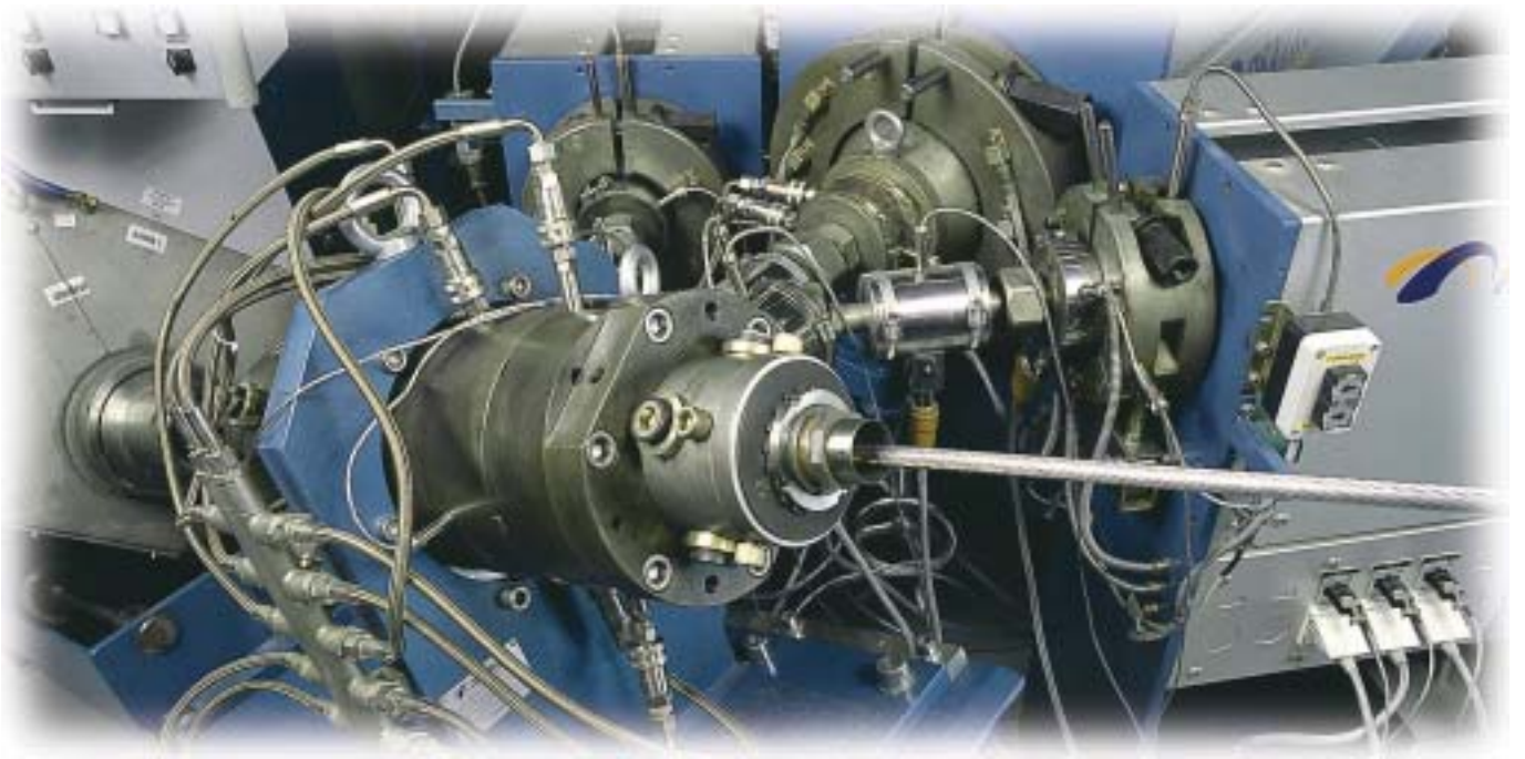
Riihimäen kuivavulkanointilinjan kolmikerrospuristinpää
